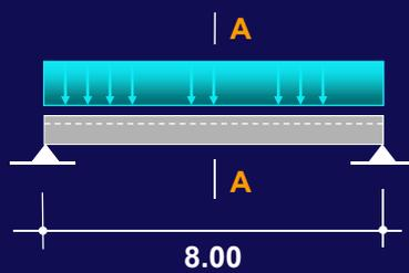
sobrecarga  $q_{\text{nom}} = 15.0 \text{ kN/m}$
